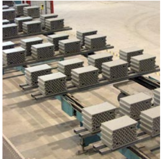
Porothermi telliste tootmine Wienerbergeri ASI Aseri tehases.
